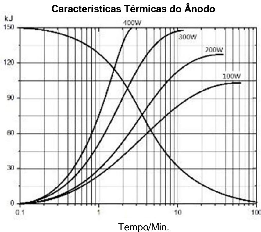
Curvas de Aquecimento e arrefecimento do conjunto de Tubo de Raio-X
